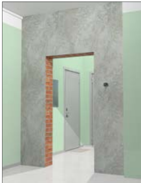
ОШТУКАТУРИВАНИЕ НАРУЖНОЙ И ВНУТРЕННЕЙ СТОРОНЫ
