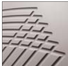
НЕГЛУБОКАЯ ФРЕЗЕРОВКА ПОЛУ-КРУГЛОЙ ФРЕЗОЙ 10x5 ММ.
