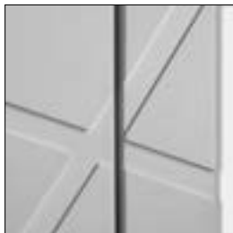
ФРЕЗЕРОВКА ПРЯМОЙ ФРЕЗОЙ ДИАМЕТРОМ 25 ММ И ПЕРЕХОД РИСУНКА С ПАНЕЛИ НА НАЛИЧНИК
