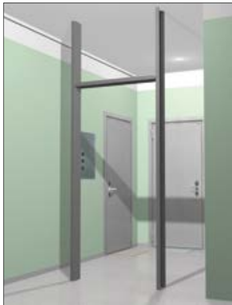
УСТАНОВКА H-ОБРАЗНОГО КАРКАСА ИЗ ШВЕЛЛЕРА
