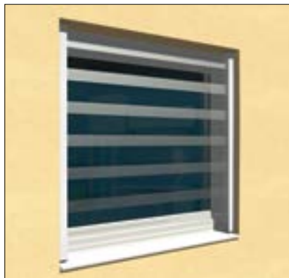
ЗАЩИТА ОКНА, РЕШЁТКИ ВНУТРИ ПРОЁМА
