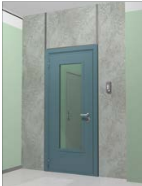
ОШТУКАТУРИВАНИЕ НАРУЖНОЙ И ВНУТРЕННЕЙ СТОРОНЫ
